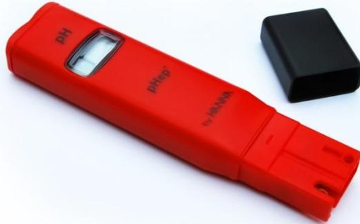
Das pHep ist ein elektronisches pH-Mess- und Anzeigegerät. Serienmäßig ist es mit einer Digitalanzeige, zwei Potentiometern zur Kalibrierung sowie einer pH-Glas- und einer Bezugselektrode ausgerüstet. Der kompakte Gehäuseaufbau ermöglicht eine schnelle pH-Messung im Labor und im Betrieb.
