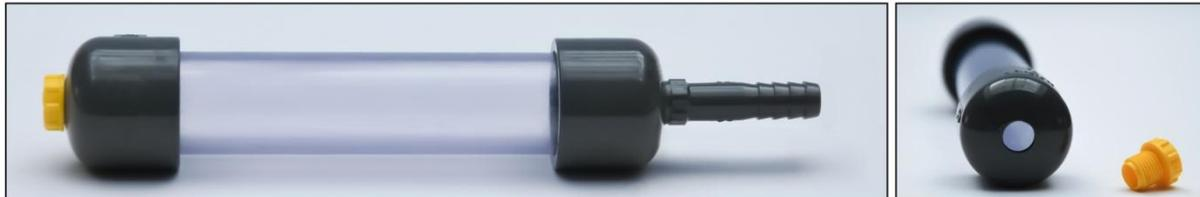
Das KCl-Gefäß dient der kontinuierlichen Elektrolytnachfüllung von pH- und rH-Einstabmessketten sowie Bezugselektroden, die mit einer Nachfüllmöglichkeit (über Schlaucholive) ausgerüstet sind. Ein nachträglicher Anbau an bereits bestehende Armaturen, wie beispielsweise Eintaucharmaturen, ist möglich.
